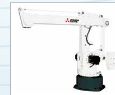
RV-100TFHL/150TFHL-D/Q 可搬重量：100kg/150kg 最大可達半徑：2730mm 上下行程：2150mm
