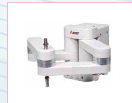
RP-5AH 可搬重量：5kg 作業領域：300×210 (約 A4) (內接方形尺寸) 位置重複精度：±0.01mm (X、Y 方向) ※單機規格
