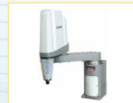
RH-OFH*** M-D/Q-SE 可搬重量：6~20kg 最大可達半徑：350~1000mm
