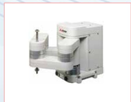
RP-1AH 可搬重量：1kg 作業領域：150×105 (約 A6) (內接方形尺寸) 位置重複精度：±0.005mm (X、Y 方向) ※單機規格
