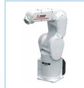
RV-4FR-D/R, RV-4F-Q 可搬重量：4kg 最大可達半徑：515mm
