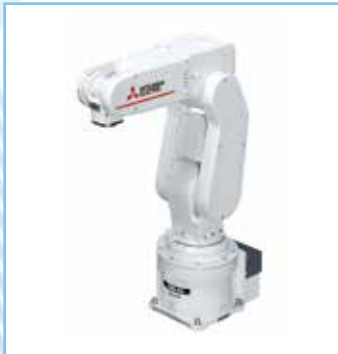
RV-2FR-D/R, RV-2F-Q 可搬重量：2kg 最大可達半徑：504mm
