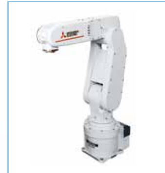
RV-2FRL-D/R, RV-2FL-Q 可搬重量：2kg 最大可達半徑：649mm
