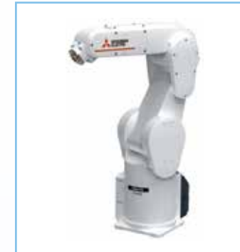
RV-4FRL-D/R, RV-4FL-Q 可搬重量：4kg 最大可達半徑：649mm
