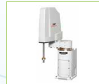
RH-6FRH35** -D/R, RH-6FH35** -Q 可搬重量：6kg 最大可達半徑：350mm
