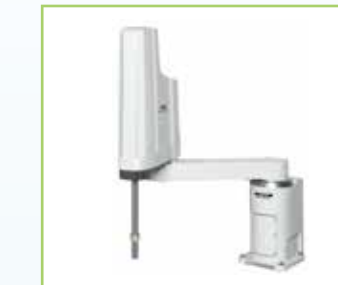
RH-20FRH85** -D/R, RH-20FH85** -Q 可搬重量：20kg 最大可達半徑：850mm
