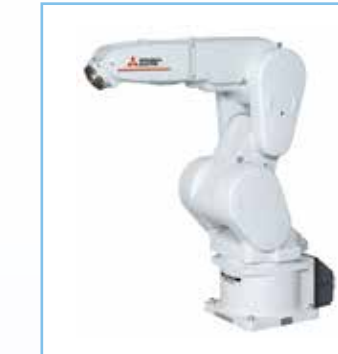
RV-20FR-D/R, RV-20F-Q 可搬重量：20kg 最大可達半徑：1094mm
