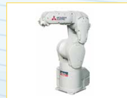
RV-OFM-D/Q-SE 可搬重量：4~20kg 最大可達半徑：515~1503mm
