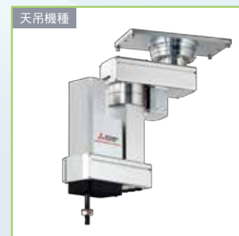
RH-3FRHR35** -D/R 可搬重量：3kg 最大可達半徑：350mm 上下行程：150mm 無塵 (ISO Class 5)、防水 (IP65)： 上下行程 120mm
