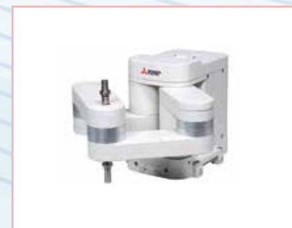
RP-3AH 可搬重量：3kg 作業領域：210×150 (約 A5) (內接方形尺寸) 位置重複精度：±0.008mm (X、Y 方向) ※單機規格
