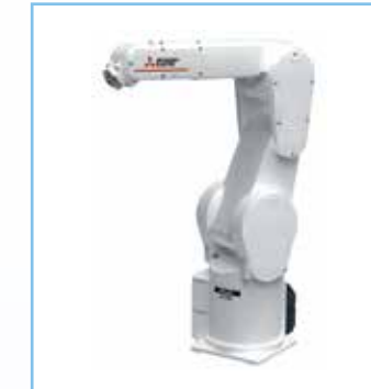
RV-7FRL-D/R, RV-7FL-Q 可搬重量：7kg 最大可達半徑：908mm
