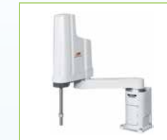
RH-12FRH85** -D/R, RH-12FH85** -Q 可搬重量：12kg 最大可達半徑：850mm
