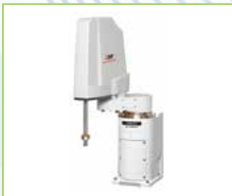
RH-3FRH35** -D/R, RH-3FH35** -Q 可搬重量：3kg 最大可達半徑：350mm
